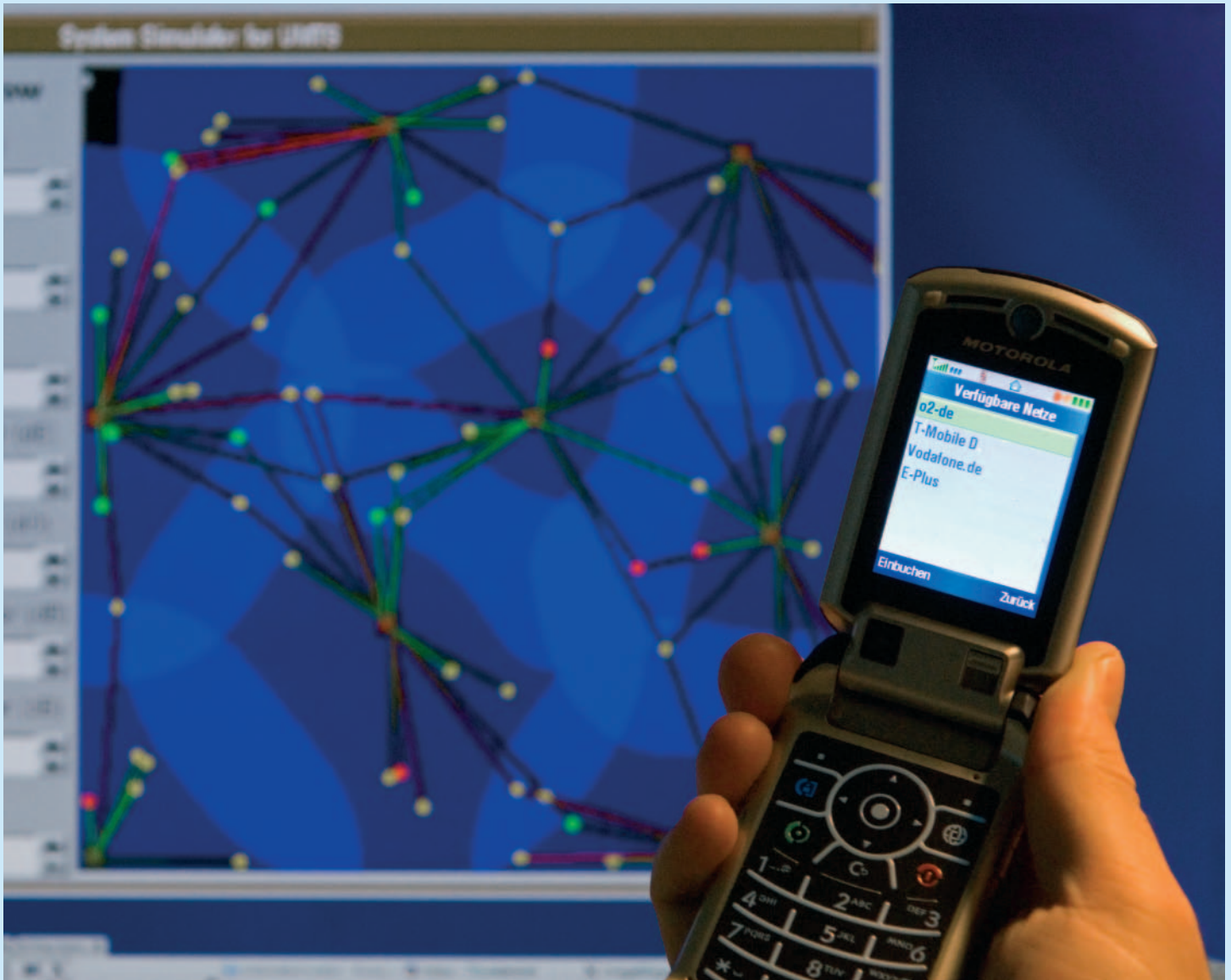
Bild 7: Mit Simulationssoftware, die große Bereiche von Mobilfunknetzen abbildet, wie hier ein UMTS-Simulator, werden neue Optimierungsverfahren zur Steigerung von Qualität und Kapazität der Netze erforscht. Dabei werden auch Messungen und Planungsdaten realer Mobilfunknetze einbezogen. Foto: Peter Winandy
